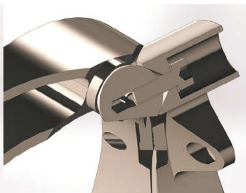
Рис. 7. Разрез верхнего узла крепления по фиксированной на плите шаровой опоре
