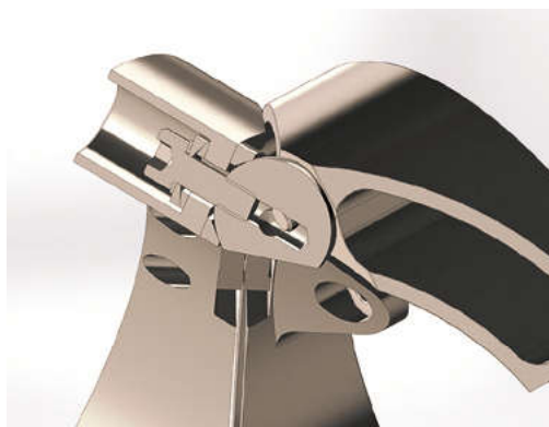
Рис. 8. Разрез «свободного» верхнего узла крепления по шаровой опоре
