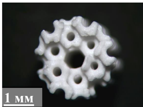
Рис. 13. Фотография керамического каркаса цилиндрической формы со структурой Кельвина вдоль направления [111]. Диаметр пор 500 мкм.
