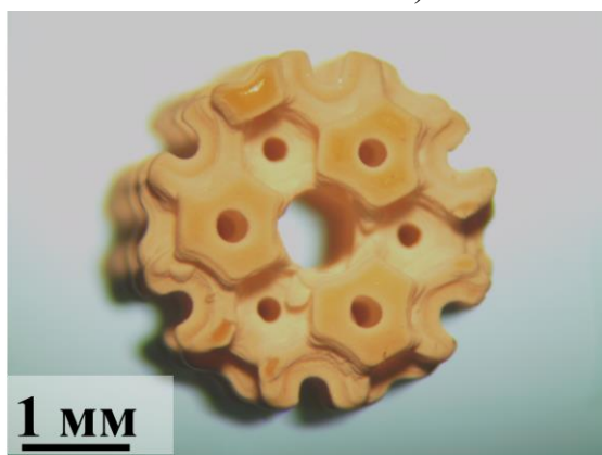
Рис. 12. Фотография композита (полимер/порошок) цилиндрической формы со структурой Кельвина вдоль направления [111]. Диаметр пор 500 мкм.
