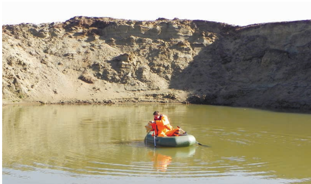
Фото 5. Батиметрическое обследование озера Антипаютинской воронки (фото А.В. Хомутова)
