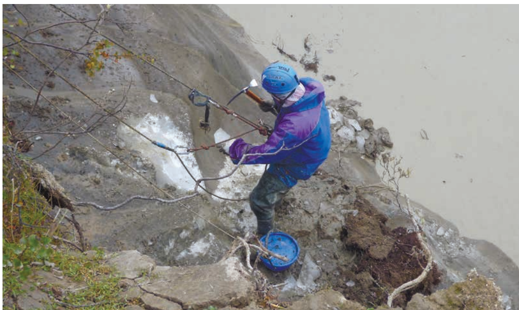
Фото 3. Отбор монолитов пластового льда из стенки ямальской ВГВ-1, сентябрь 2015 г. (фото А.В. Хомутова)
