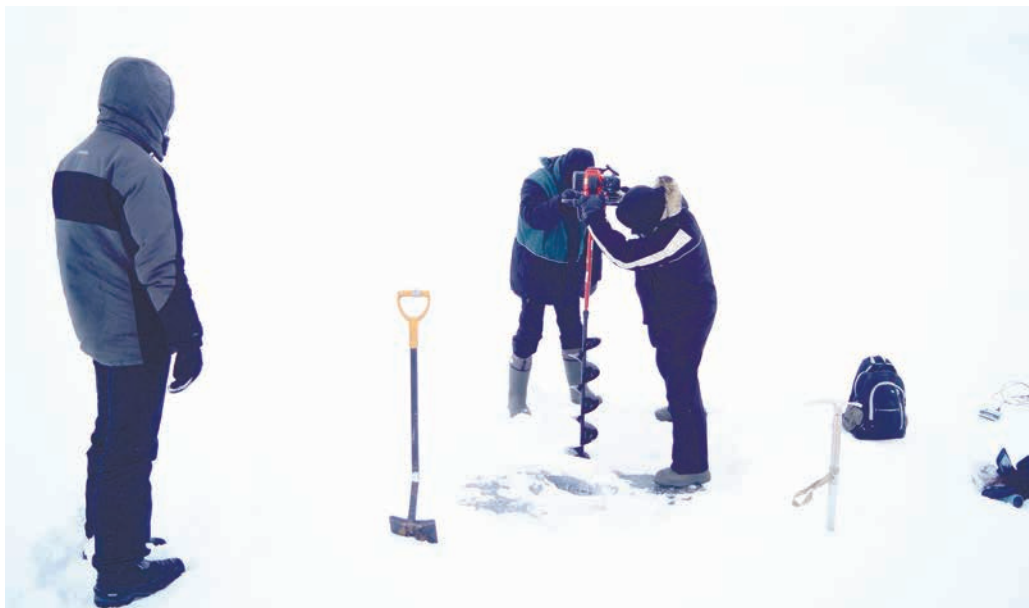
Фото 8. Бурение льда озера ямальской ВГВ-1 для последующего отбора проб льда и воды, в том числе для определения концентрации растворенного метана (фото Е.М. Бабкина)
