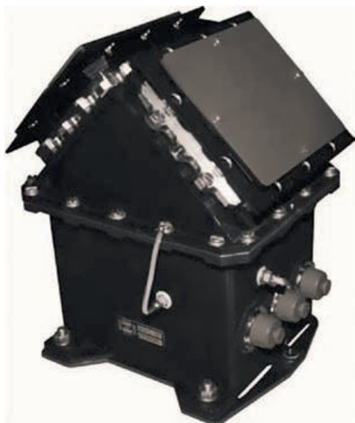
рисунок 3. Солнечный датчик БОКС-01 разработки НПП «Оптэкс» с двумя оптическими щелевыми масками и фотоприёмниками
