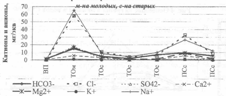
Рис. 6 Химический состав вод СТС на разновозрастных оползнях
