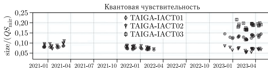
Рис. 4. Изменение интегральной «квантовой чувствительности» трех телескопов установки TAIGA-IACST в период 2020–2023 гг. Каждая точка характеризует ошибку среднего значения эффективности регистрации черенковских фотонов телескопом за один сеанс наблюдений, содержащий не менее 250 совместных событий TAIGA-IACST и TAIGA-HiSCORE
