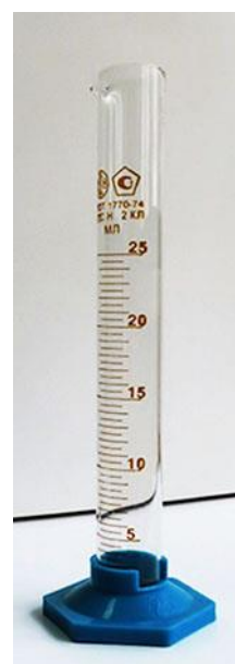
Рис.2. Мензурка для измерения объема цилиндрического сосуда
