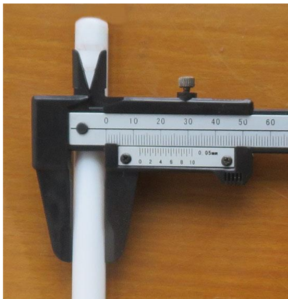
Рис.4. Измерение диаметра цилиндрической палочки штангенциркулем.
