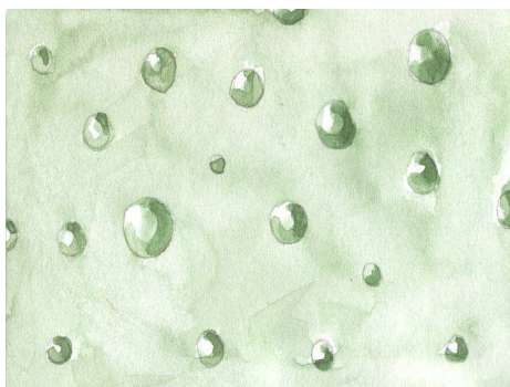
Рис.5. Структура глазури, глушеной капельной ликвацией
