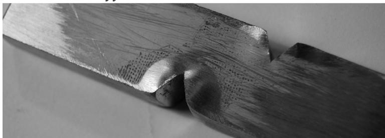
*Рис.10. Торец образца после нагружения*
