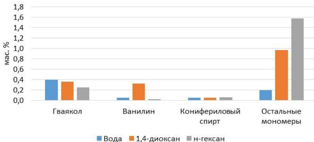
Рис 2. Распределение продуктов в экстрактах гидролизованного лигнина при 250 °С и 9 МПа в разных растворителях.
