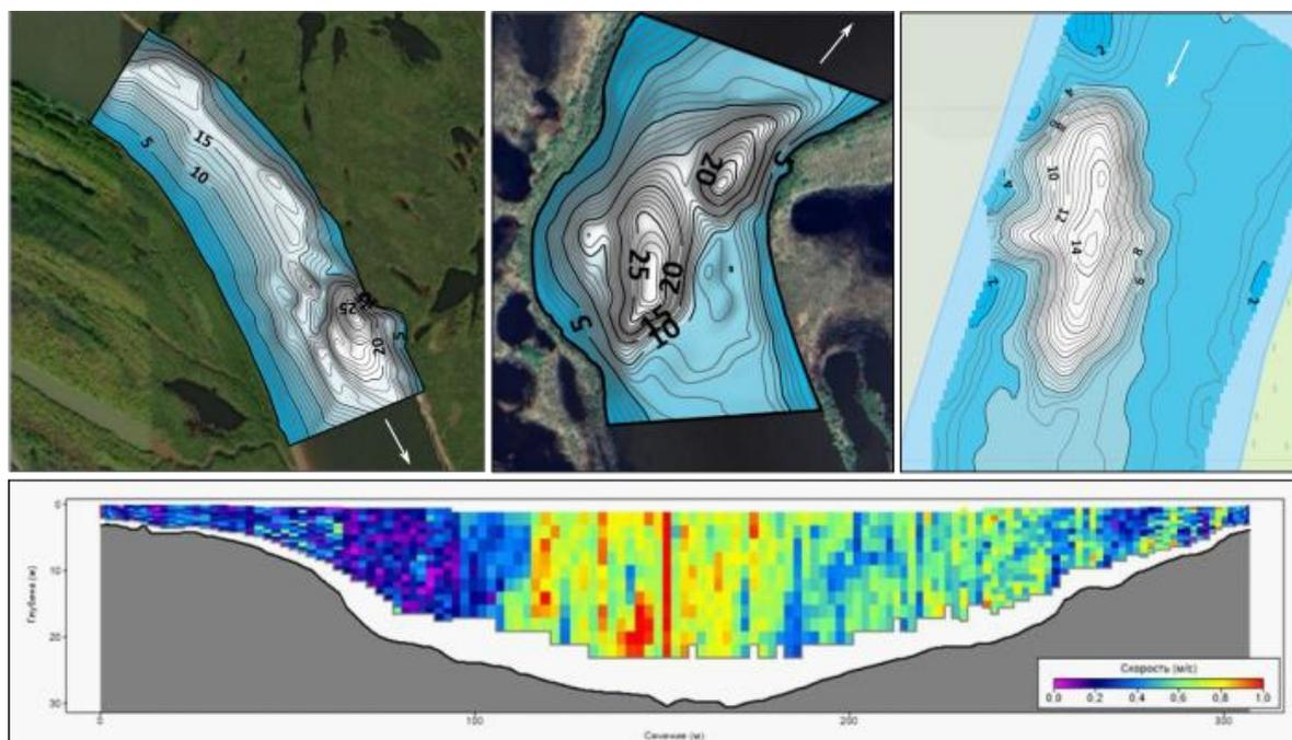
Рис. 4. Батиметрия, предположительно, наиболее молодых из обследованных ям (сверху) и характерное распределение скоростей по поперечному сечению ямы в половодье (снизу)
