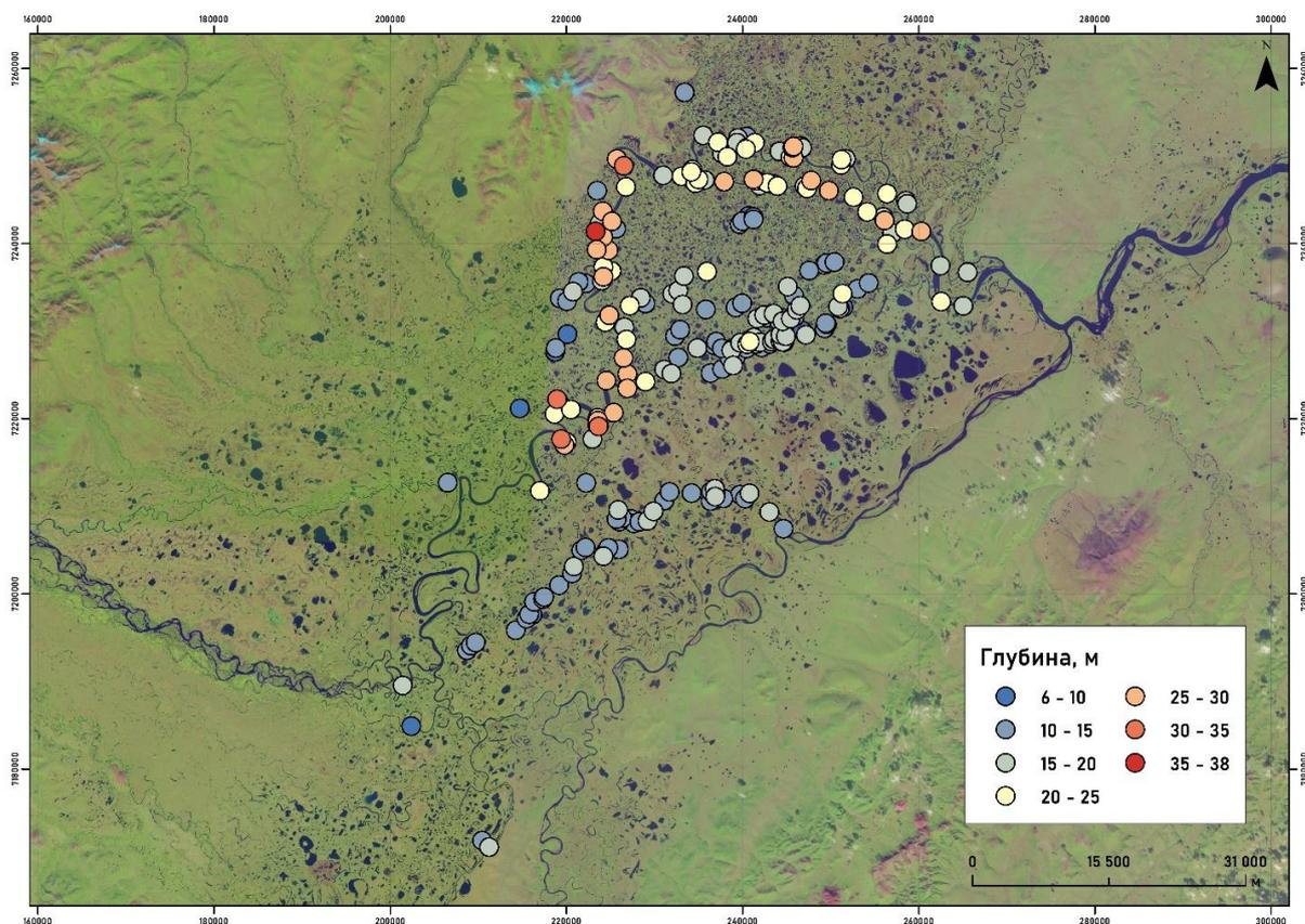
Рис. 3. Распределение глубин ям в пределах разветвления
