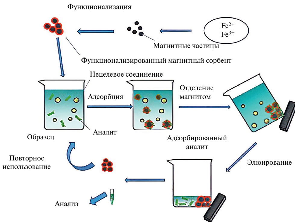
Рис. 2. Схема проведения магнитной твердофазной экстракции [60].
