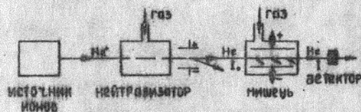
Рис. 7. Схема экспериментальной аппаратуры, используемой группой Гилбоди [8,15]
