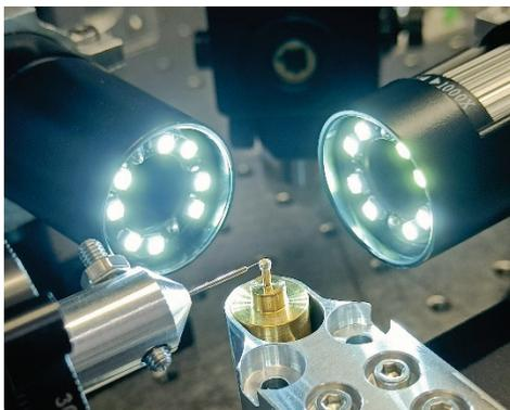
Рис. 2. Фотография установки по измерению добротности.
