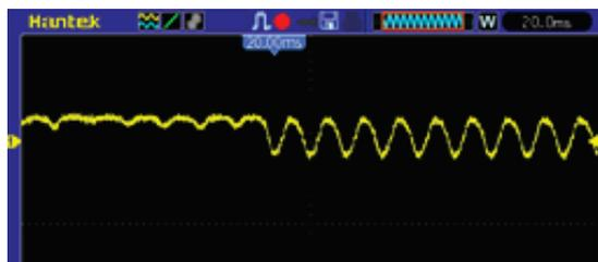
Рис. 1. Осциллограмма колебаний интенсивности света проходящего через датчик.
