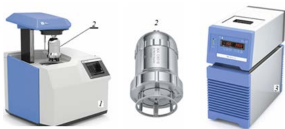
Рис. 2. Вид калориметрической установки; 1 – калориметр С 6000 isoperibol; 2 – сосуд для разложения С 6010; 3 – система снабжения охлаждающей жидкостью RC 2 basic
