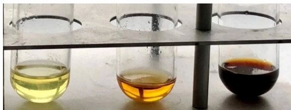
Рис. 4. Внешний вид реакционной массы при 150°C, 170°C и 190°C (слева направо)
