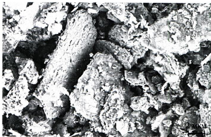
Рис. 2. Микрофотографии порошка, синтезированного из водных растворов формиата кальция и гидрофосфата аммония с концентрацией 0,5М при заданном соотношении \text{Ca/P} = 1 , после дезагрегации
