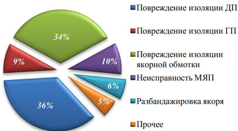
Рисунок 1 – Распределение отказов ТЭД электропоездов моторвагонного депо Санкт-Петербург-Балтийский по видам неисправностей
