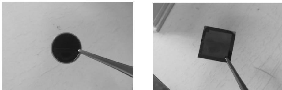
Рис. 1. а - Внешний вид готовой кремниевой пластины, б – Внешний вид пластины для контроля перед химическим округлением
