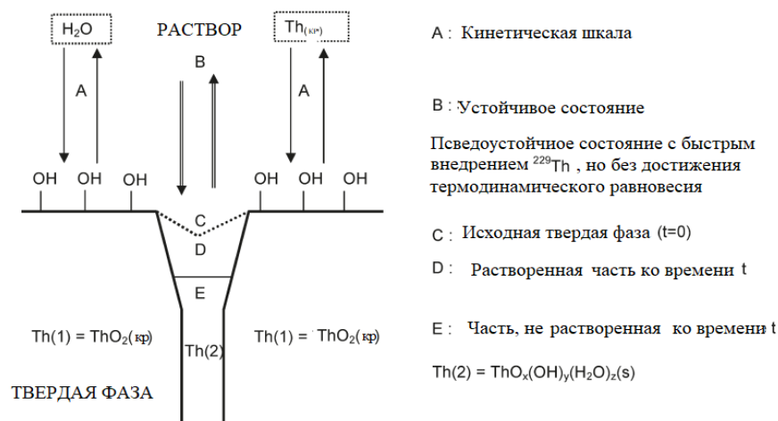
Рис.2. Схема границы зерна \text{ThO}_2(\text{кр}) и механизм его растворения [3].
