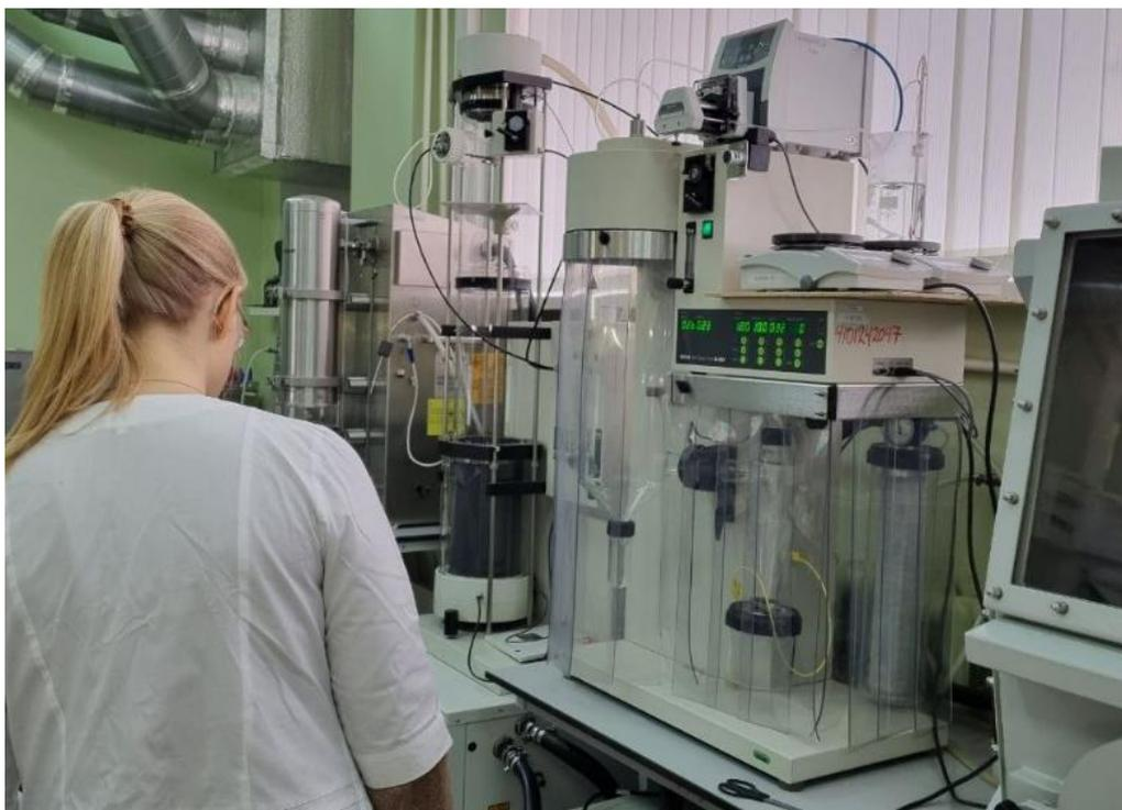
***Рис. 4. Вид лабораторной установки Spray drying по исследованию процессов интенсивной полимеризации закупоривающего агента***
