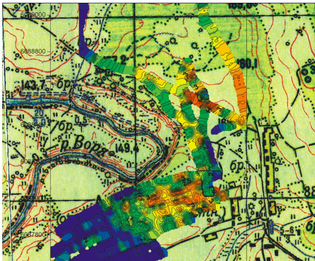
Рис.10. Карта сопротивлений БИЭП 37 м на топооснове. Синий цвет шкалы сопротивлений - суглинки, желтый и красный - пески.
