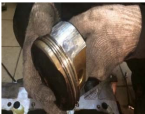
Рис.6. Задиры в зоне юбки поршня
