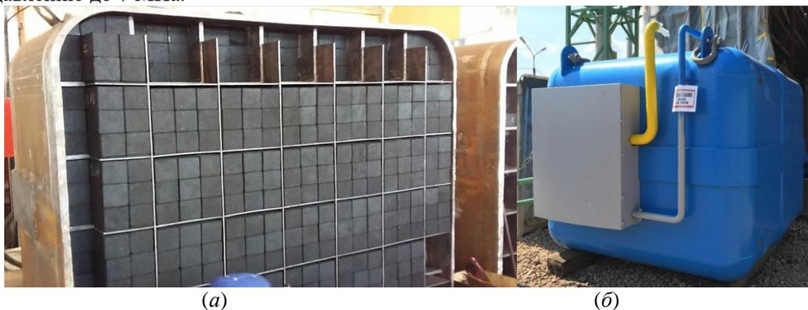
Рисунок 1 – Внешний вид блоков функционального углеродного пористого материала (а) внутри адсорбционного газового терминала (б) [3]
