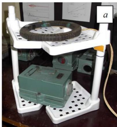
Рисунок 1. Общий вид лабораторного оборудования эксперимента по проверке воздействия магнитного поля на сейсмометры: (а) – СМ-3КВ; (б) – STS-2
