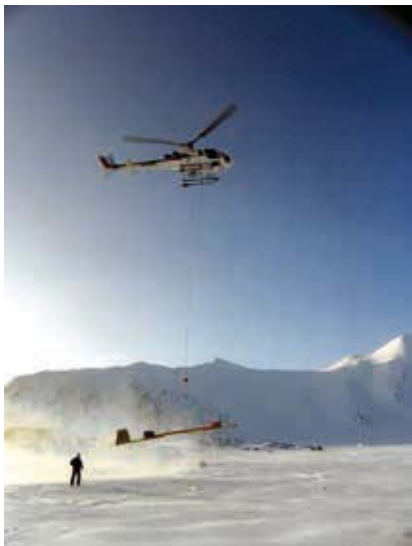
Рис. 8 Вертолёт с моноимпульсным локатором ВИРЛ-6 на подвеске, Шпицберген
