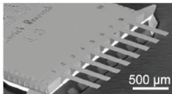
Рис. 34. Система из 8 кантилеверов с различными покрытиями может быть использована в качестве ключевого элемента химического или биологического сенсора
