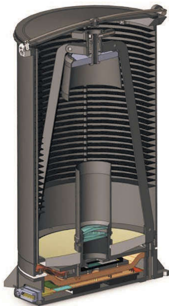
рисунок 3. Разрез высокочастотного звёздного датчика
