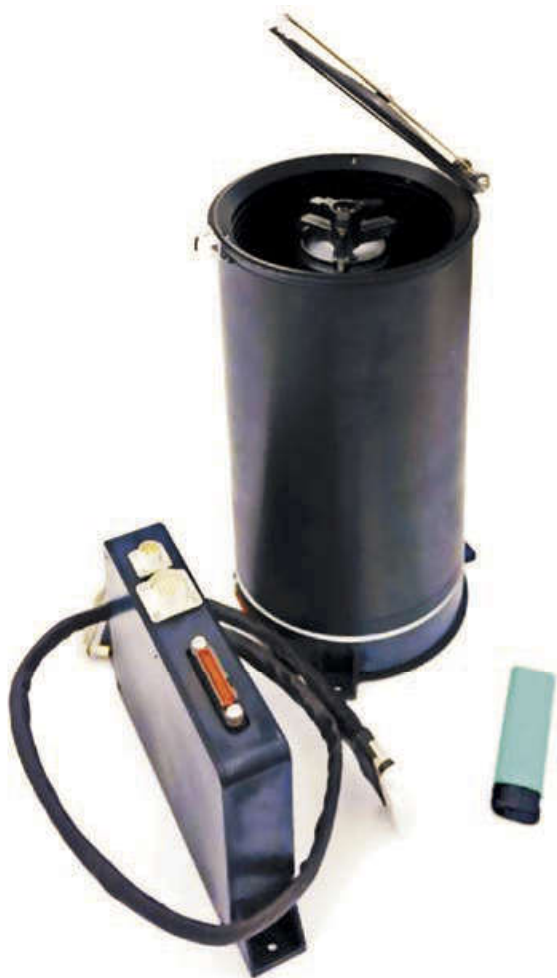
рисунок 2. Внешний вид прототипа высокочастотного звёздного датчика
