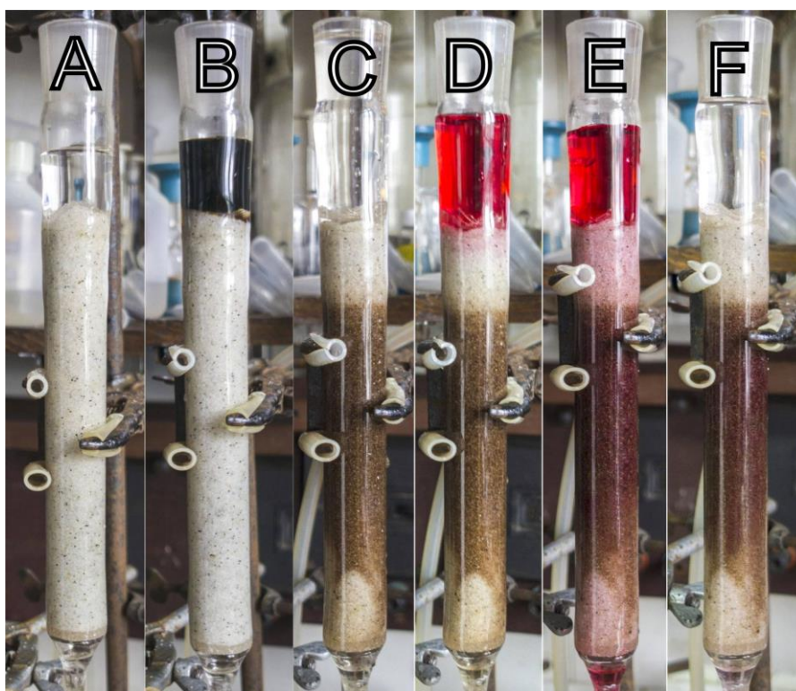
Рисунок 14 – Сорбция азокрасителя прямой красный 81 на колонке с иммобилизованными ССГК. Исходная колонка с кварцевым песком (А), введение ССГК (В), иммобилизованные ССГК (С), введение азокрасителя (D,E), колонка после промывки дистиллированной водой (F)
